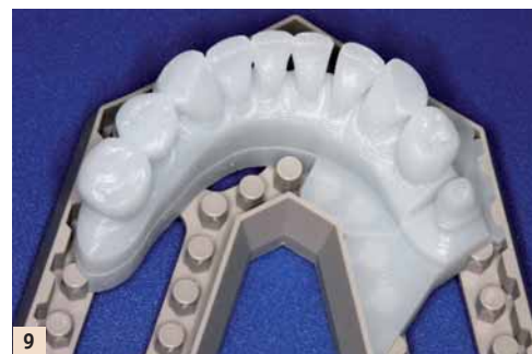
Abb. 8: Der Ganzkiefer-Scan für eine Brückenkonstruktion, System iTero. (Foto: Straumann) – Abb. 9: Stereolithografisches Kunststoffmodell (SLA), System C.O.S. Lava. (Foto: 3M ESPE)
